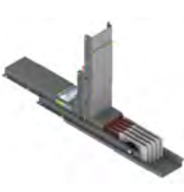
MB - BARRAMENTO BLINDADO CORRENTE: 160A - 630A GRAU DE PROTEÇÃO: IP54 CONDUTOR: COBRE - ALUMÍNIO CLASSE DE TENSÃO: 1kV NBR IEC 60439-1/2
