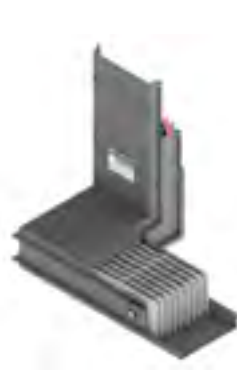
MV - BARRAMENTO VENTILADO CORRENTE: 630A - 6.000A GRAU DE PROTEÇÃO: IP31 CONDUTOR: COBRE - ALUMÍNIO CLASSE DE TENSÃO: 1kV NBR IEC 60439-1/2
