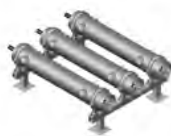
MT-FI - BARRAMENTO FASES ISOLADAS CORRENTE: 2500A - 20000A GRAU DE PROTEÇÃO: IP65 CONDUTOR: COBRE - ALUMÍNIO CLASSE DE TENSÃO: 15kV até 38,0kV ANSI C37.23
