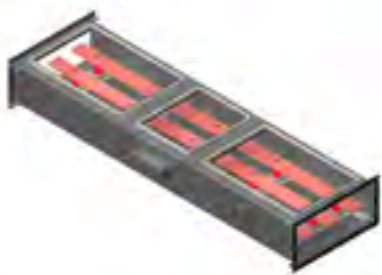
MT-FN - BARRAMENTO FASES NÃO SEGREGADAS CORRENTE: 800A - 4500A GRAU DE PROTEÇÃO: IP55 CONDUTOR: COBRE - ALUMÍNIO CLASSE DE TENSÃO: 4,16kV até 38,0kV ANSI C37.23 IEC 62.271-200
